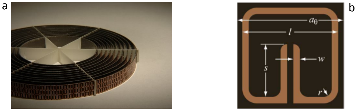
1.2.-es ábra: Az (a) ábrán a kísérleti elrendezés látható, ahol a köpenyt 10, egységcellákból összerakott metaanyag rétegből állították elő. A (b) ábrán egy SRR egységcella látható a geometriai paraméterekkel.
