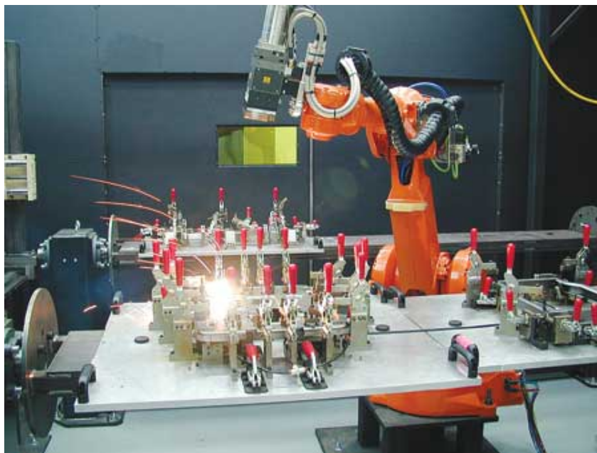
1. ábra. Távoli lézerhegesztés, hegesztő robot [1]
