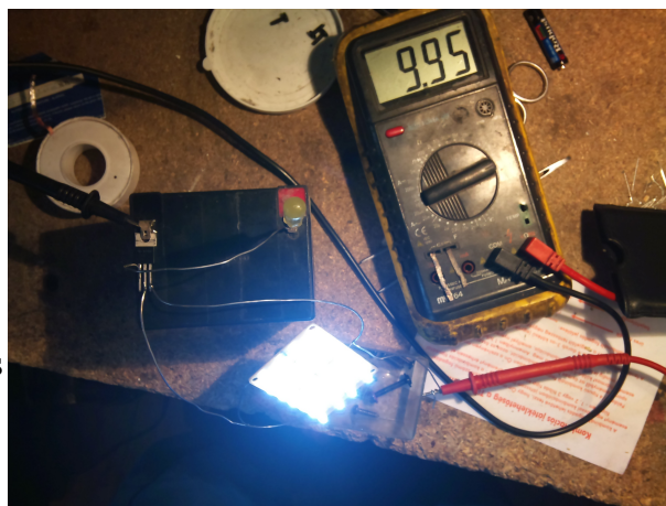
Akku, stabtok, multiméter és a hidegfehér ledsor
