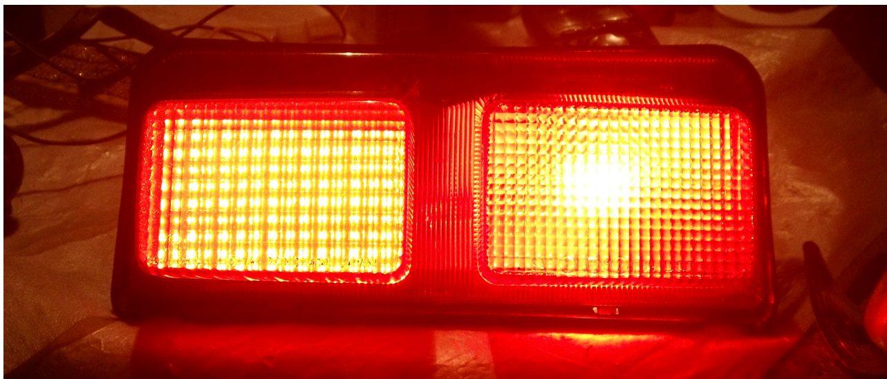
A képen „helyzetjelző állásban” látható a ledsor és izzó.
