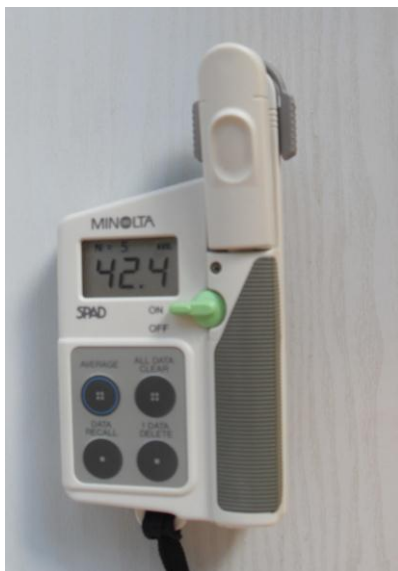
1. kép: SPAD-502 relatív klorofill mérő készülék (Fotó: Bodnár K., 2012)
