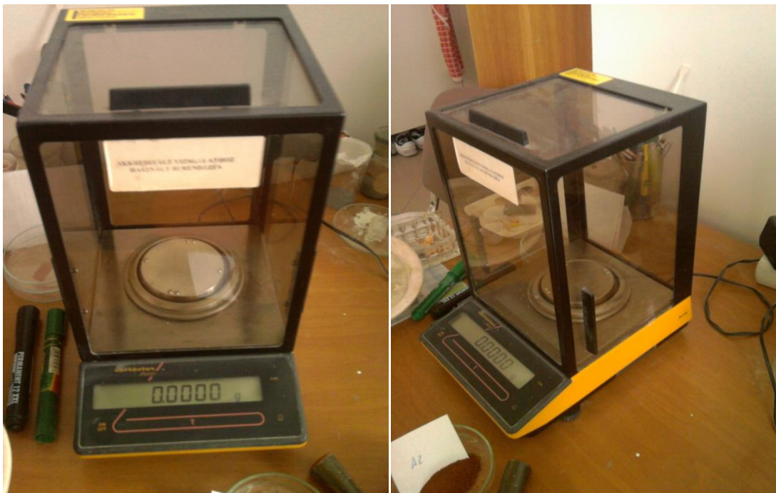
VIII. ábra: A mérésnél használt 10^{-4} gramm pontosságú analitikai mérleg két nézetből
