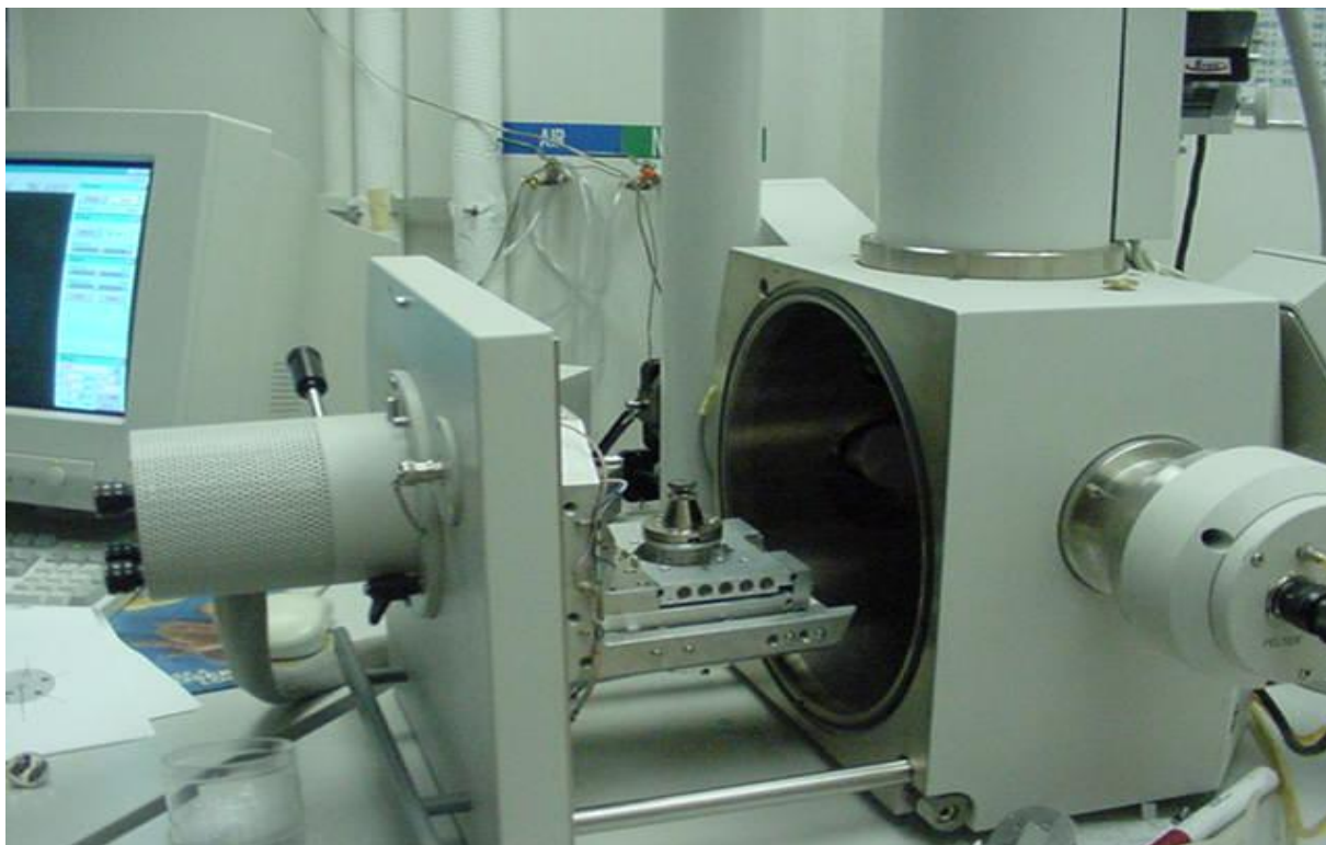
XI. ábra: Pásztázó Elektronmikroszkóp (SEM) a képen látható berendezéshez hasonlóval készítettünk képeket a CH épületben [14]
