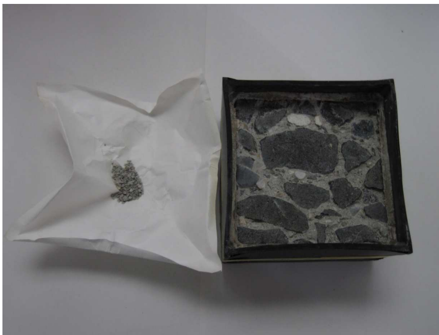
7. fénykép: Fagylehámítás vizsgálat
