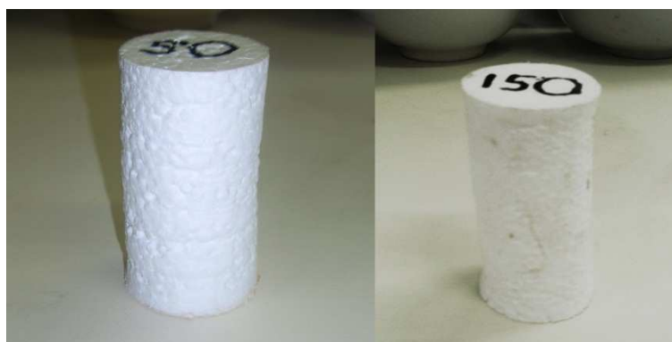
6. ábra: 50 és 150 kPa-os hidrosztatikus nyomással terhelt minták a vizsgálat után
