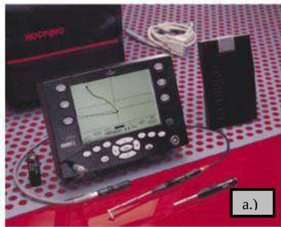
18. ábra: a.) Locator 2 örvényáramos mérőműszer tartozékai; b.)A szonda
