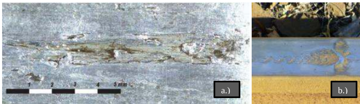
22. ábra: a.) mikro megcsúszás mikroszkópos felvétele; b.) Indulási kerék kipörgés a sín futó felületén
