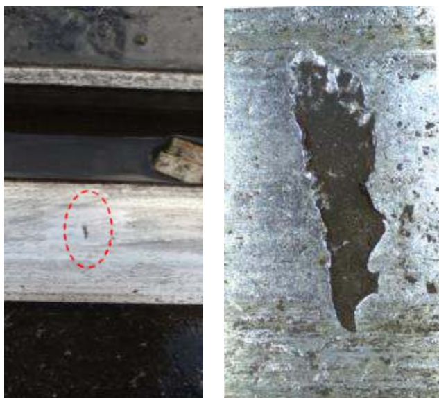
12. ábra: A Deák téren lapos kerék okozta tönkremenetel
