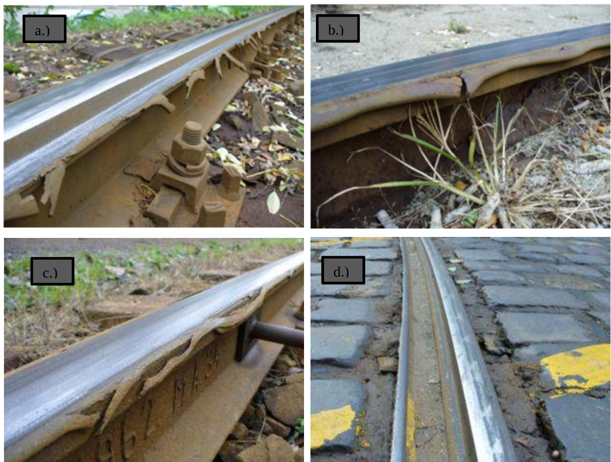
10. Fényképek: (a) Oldalkopás legyűrődése ívben;(b) A sínfej legyűrődése;(c) A sínfej futófelületének lemezes legyűrődése;(d) Széles nyomcsatorna a sínfej kopása miatt
