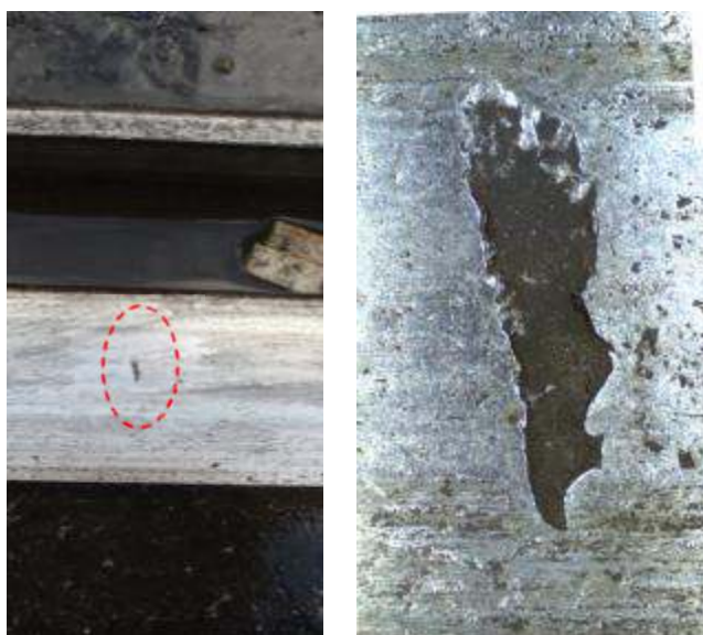
8. ábra: A Deák téren lapos kerék okozta tönkremenetel
