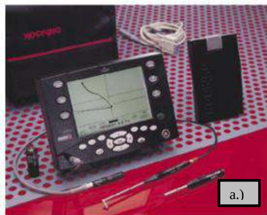
19. ábra: a.) Locator 2 örvényáramos mérőműszer tartozékai; b.)A szonda
