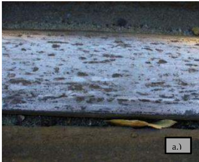
6. Fénykép: a.) Hosszirányú meghibásodás a sínfejen (vályús sín) b.) a nagyvasúti head checking
