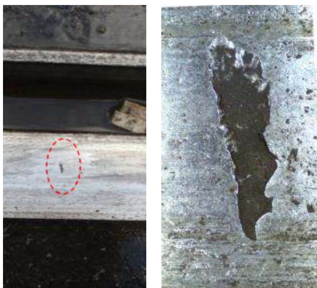
DK1. ábra: A Deák téren lapos kerék okozta tönkremenetel
