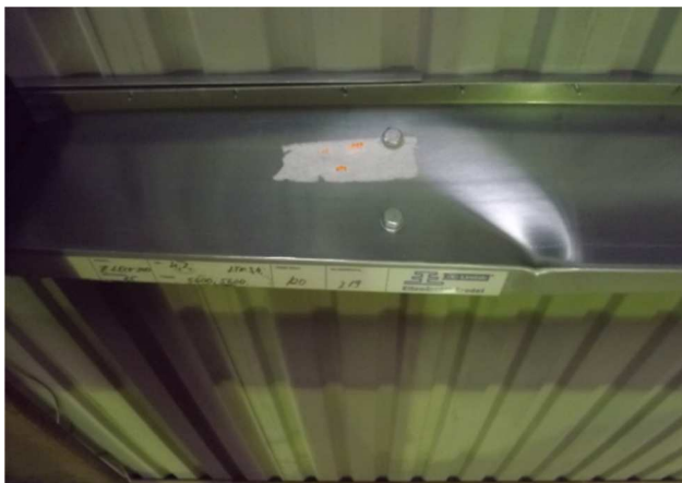
10. kép és 32. ábra: Z200ECO szelemen valós illetve numerikus tönkremenetele, átlapolásnál
