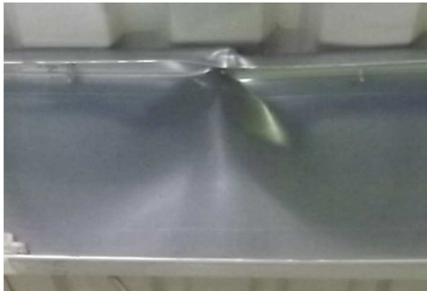
7. kép és 20. ábra: Z200ECO szelemen valós illetve numerikus tönkremenetele, mezőközépen
