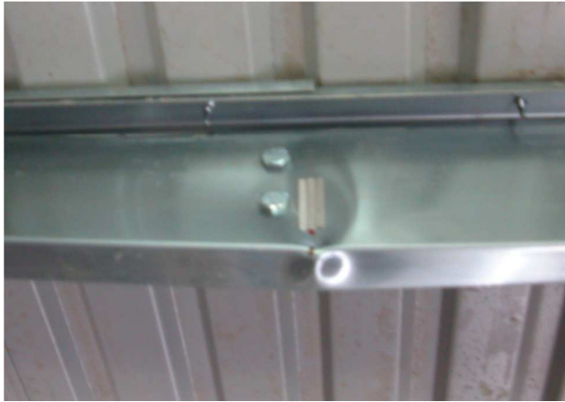
9. kép és 25. ábra: Z150 szelemen valós illetve numerikus tönkremenetele, átlapolásnál
