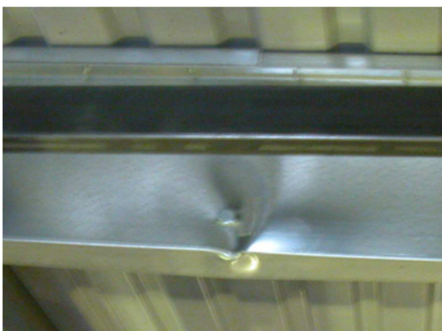
11. kép és 33. ábra: Z250 szelemen valós illetve numerikus tönkremenetele, átlapolásnál
