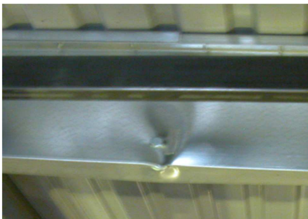
11. kép és 27. ábra: Z250 szelemen valós illetve numerikus tönkremenetele, átlapolásnál
