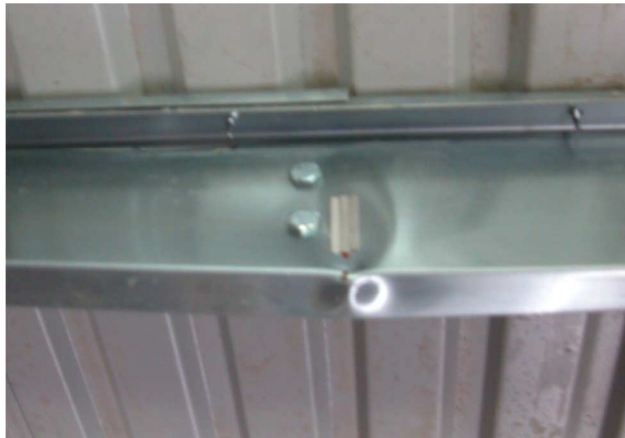
9. kép és 31. ábra: Z150 szelemen valós illetve numerikus tönkremenetele, átlapolásnál
