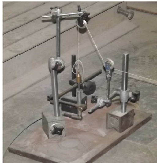
b) Indukciós adó kialakítása
