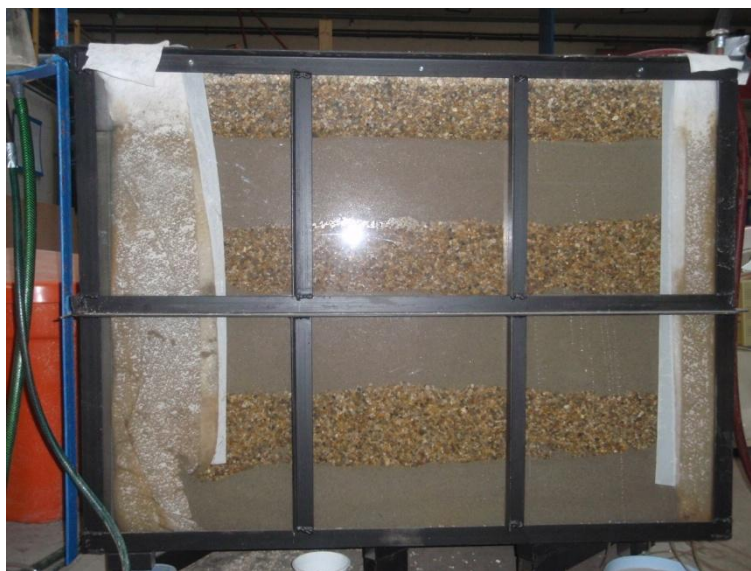
4.1. kép Kismintamodell oldalnézetből, hat rétegben beépített anyaggal
