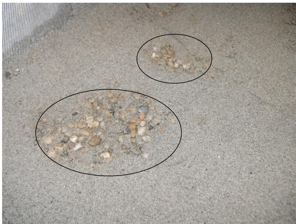
4.3. kép Réteg összemosódások felül kavics, alul homok esetén
