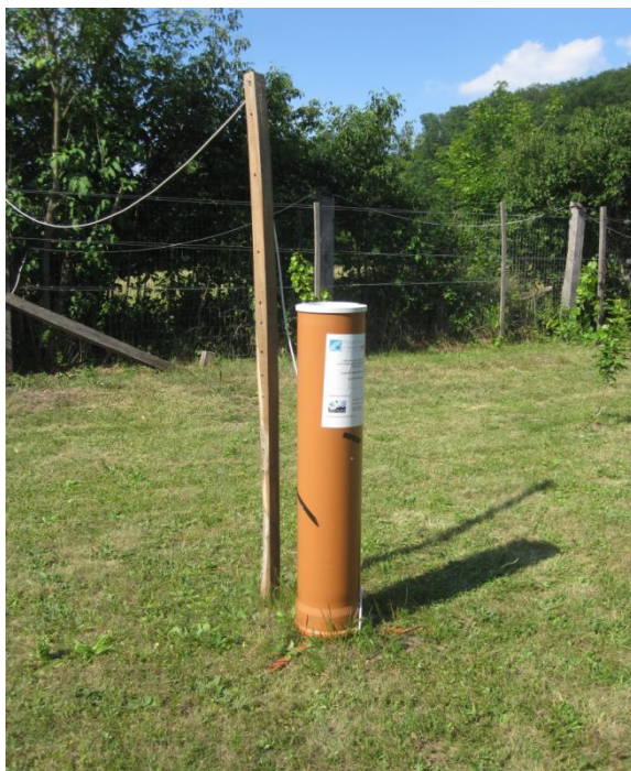
2. kép: Csapadék intenzitásmérő műszer védőhengerben, Sikáros.
