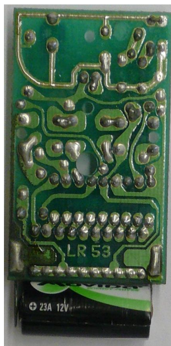
4. kép. ZTX321 típusjelű rádió távirányító adó
