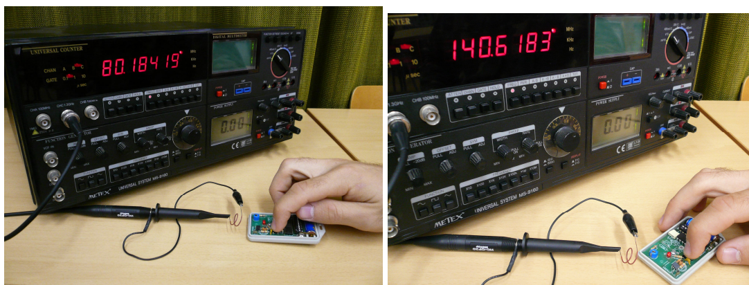
20. kép. A kisugárzott jel mérése digitális frekvenciamérővel
