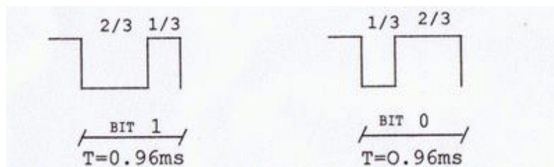
16. kép. A két állapotnak megfelelő elemi impulzusalakok 8
