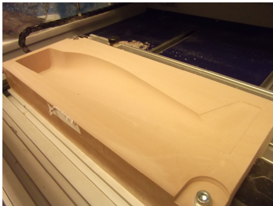
3.14. ábra: A simítás utáni kész sablon 59
