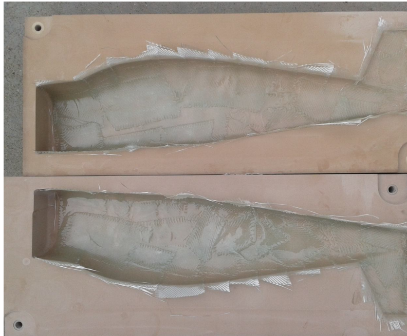
3.16. ábra: A szerszámba elkészített laminátum 61
