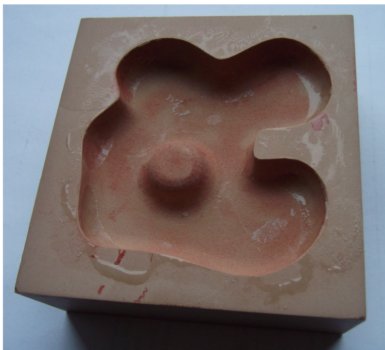
3.1. ábra: Szilikon formához alkalmazott szerszám 39
