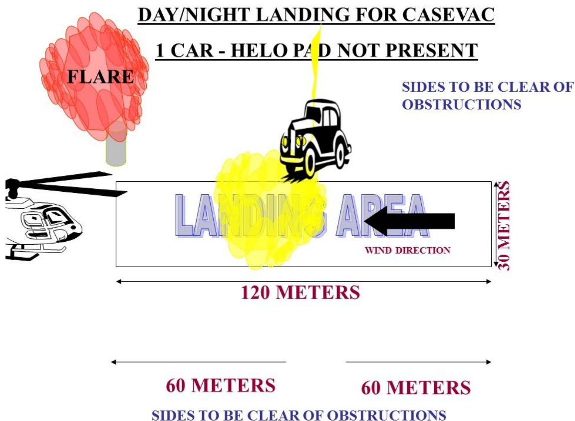
2. ábra Leszállóhely megvilágítása egy fényforrással 26
