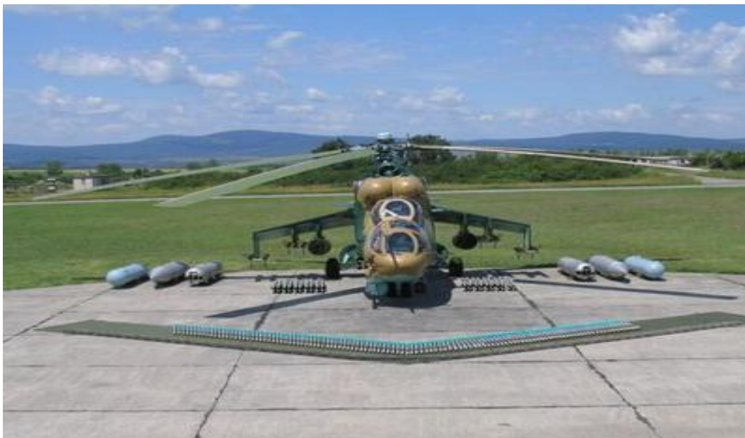
7. ábra A Mi-24D harci helikopter teljes felszerelhető fegyverzetével 92
