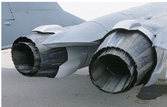
27-28. ábrák: jól megfigyelhető, hogy a fűvóka tengelye nem esik egybe a gép tengelyével. 64 65
