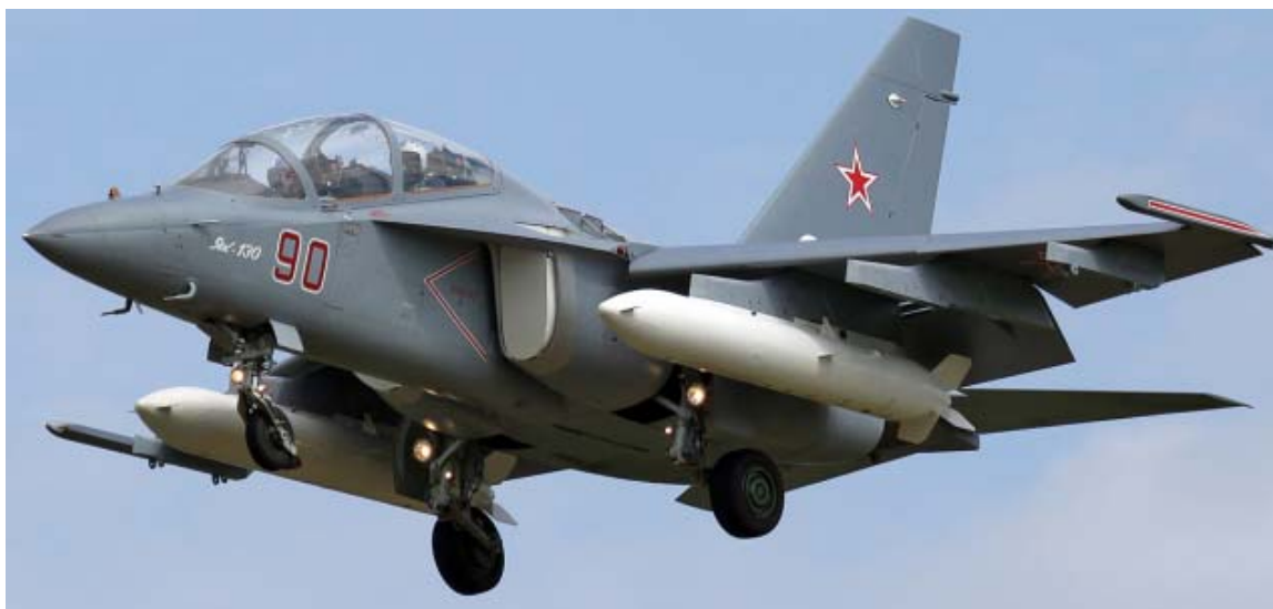
24. ábra: Jak-130 leszállás közben. A fő beömlő lezárva, a redőny nyitva. 56
