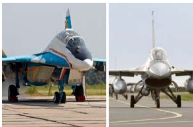
22. ábra: Jól látható a két szívócsatorna közötti magasságkülönbség. 53 54
