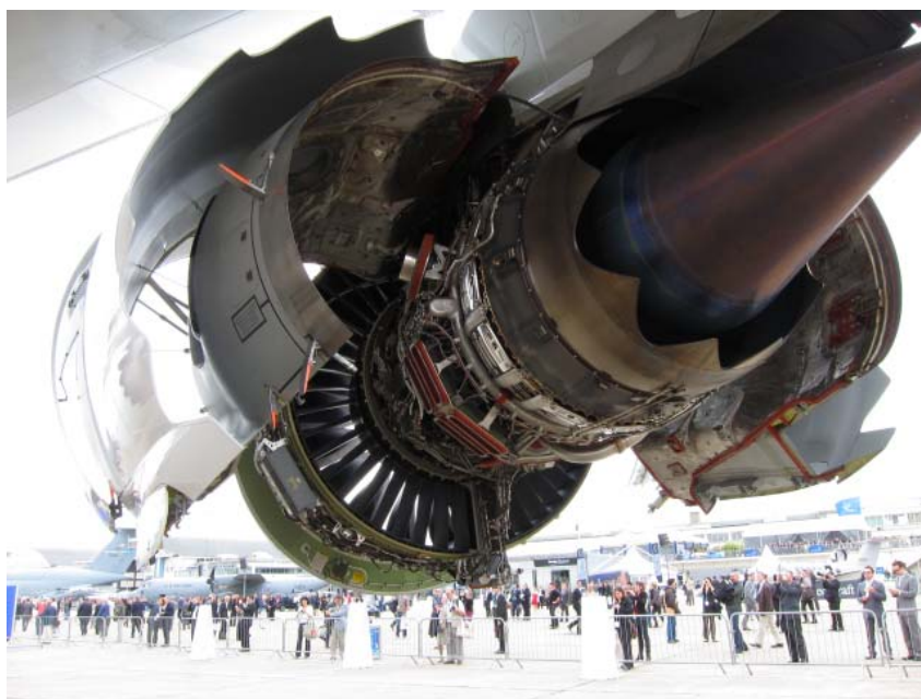
3. ábra: A GENx polgári repülőgép hajtómű. A fogazott kilépő rész a zajcsökkentésben vesz részt. 9
