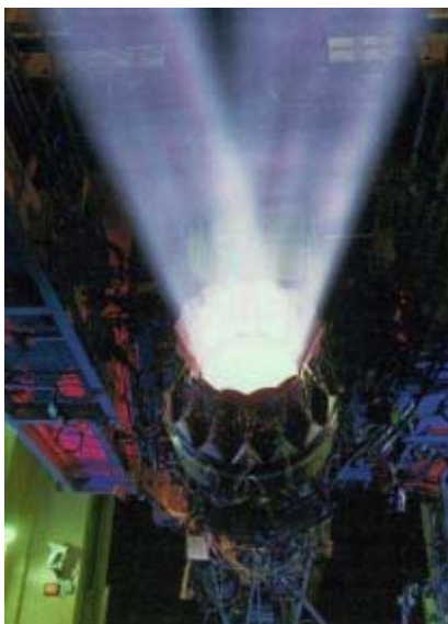
27-28. ábrák: jól megfigyelhető, hogy a fűvóka tengelye nem esik egybe a gép tengelyével. 64 65
