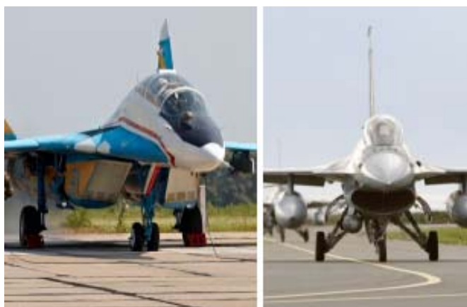
22. ábra: Jól látható a két szívócsatorna közötti magasságkülönbség. 54 55
