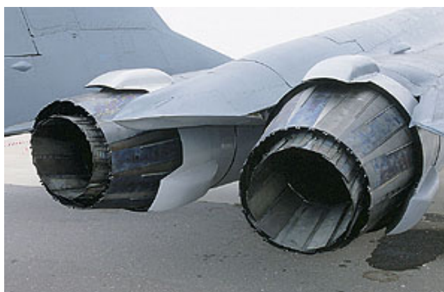
27-28. ábrák: jól megfigyelhető, hogy a GSF tengelye nem esik egybe a gép tengelyével. 65 66
