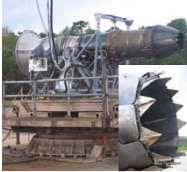
7. ábra: "Cápa fogak" a GSF kilépő részénél. 26
