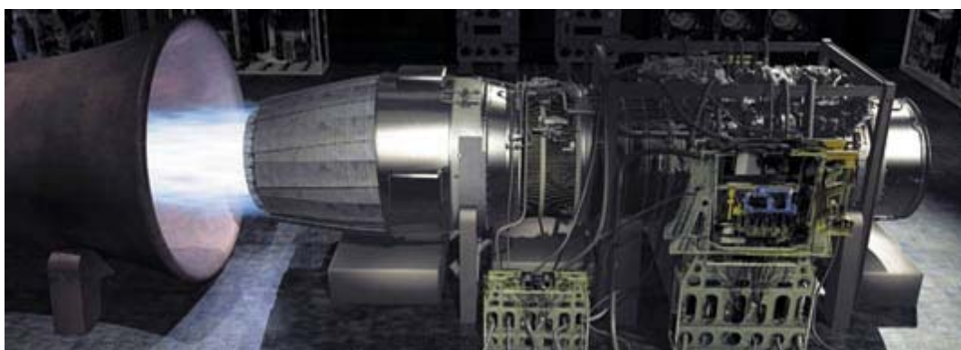
19. ábra: próbapadi tesztek a Klimov Gépgyárnál 50
