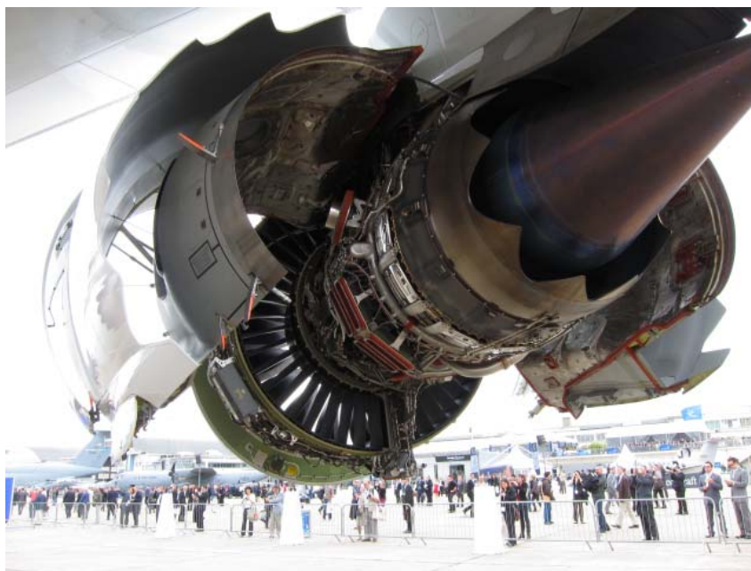
3. ábra: A GENx polgári repülőgép hajtómű. A fogazott kilépő rész a zajcsökkentésben vesz részt. 9
