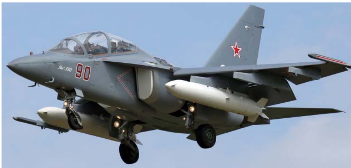
24. ábra: Jak-130 leszállás közben. A fő beömlő lezárva, a redőny nyitva. 57
