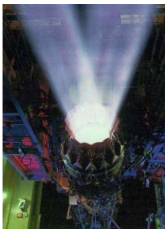
27-28. ábrák: jól megfigyelhető, hogy a GSF tengelye nem esik egybe a gép tengelyével. 65 66
