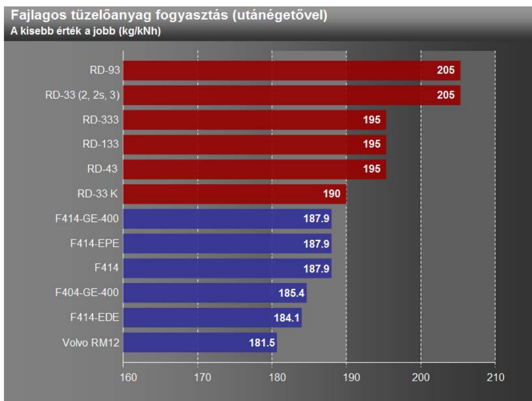
37. ábra: Fajlagos tüzelőanyag fogyasztás utánégetővel. 75
