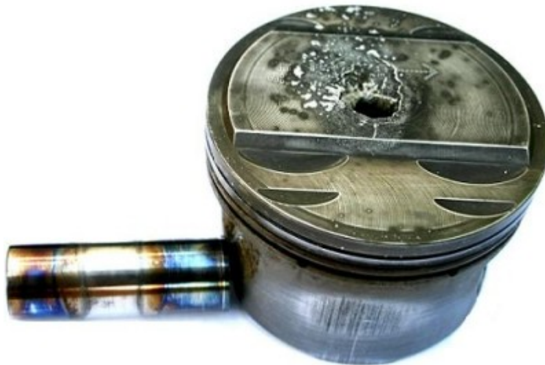
11. ábra. Megolvadt dugattyútető a kopogásos/detonációs égés miatt ; forrás: http://www.injektor.hu/index.jsp?id=2&main=118&akt=2 letöltve:2012.10.21.
