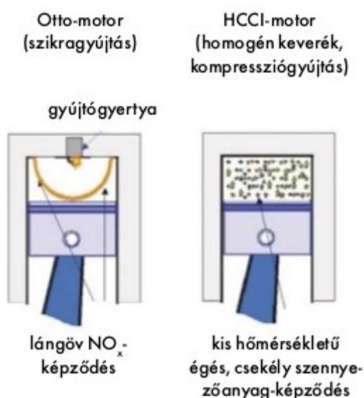
18. ábra. szikragyújtás és HCCI módban lezajló égés ; forrás: Autótechnika bizonyult.
