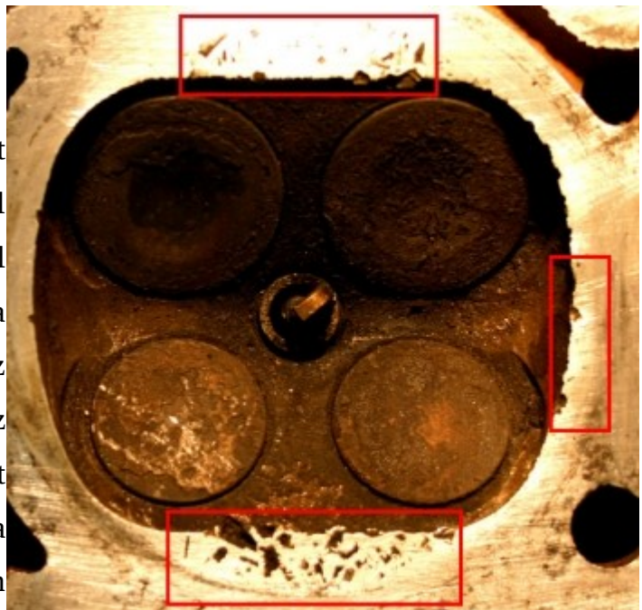
2. ábra. Rossz minőségű gyertya okozta sérülések a hengerfejen; forrás: www.injektor.hu/index.jsp?id=2&main=149&akt=2 letöltve: 2012.10.08.
