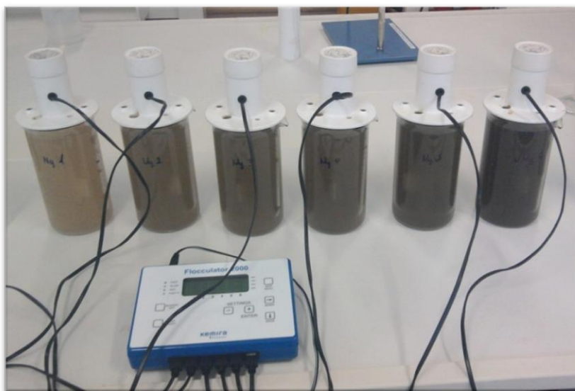
3-1. ábra – A laboratóriumi kísérletekben alkalmazott koagulációs berendezés
