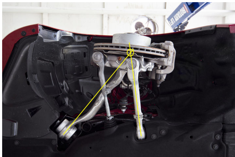
6. ábra: BMW 328i futómű virtuális bekötési pontja
