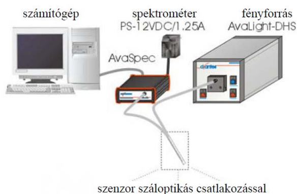
16. ábra: AvaSpec 2048 spektrofotométer részei; a mintát és a szenzort egy rögzíthető panelra helyezzük a mérés során
