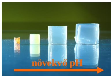
1. ábra: Hidrogélek térfogatváltozása a pH függvényében
