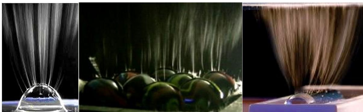
8. ábra: Gázbuborékos (baloldalon), golyós (középen) és forgó hengeres elektrosztatikus szálképzés (jobboldalon)
