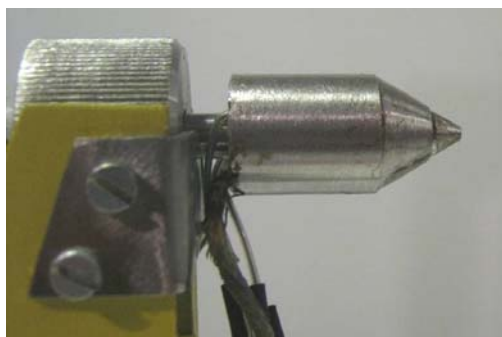
13. ábra A kapillárist tartalmazó szórófej és a fűtőegység
