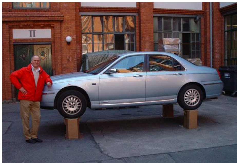
5. ábra: A Stange-féle papírszék teherbírásának demonstrálása [7]
