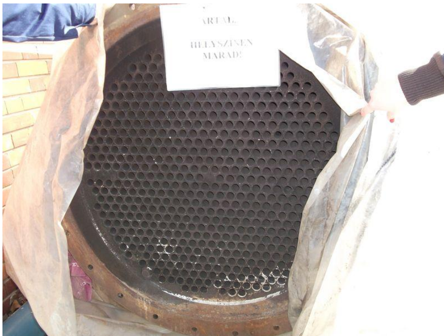
32. ábra Egy füstgáz-hőcserélő keresztmetszete
