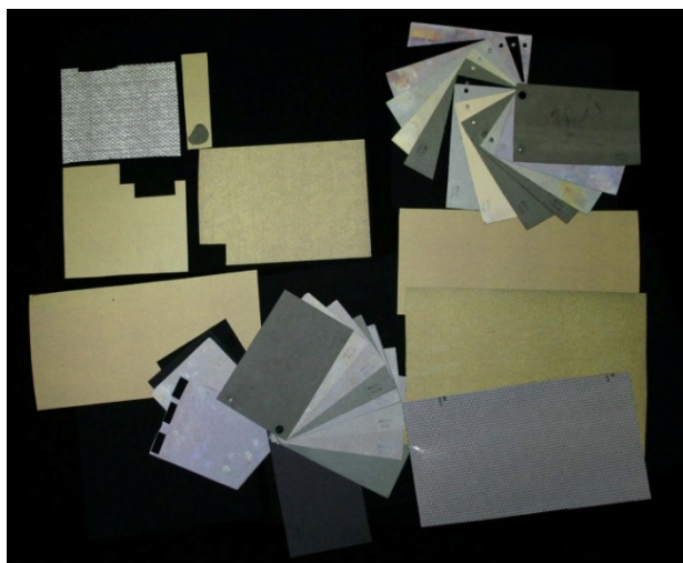
9. ábra: Retroreflektorok a kamerához közeli megvilágítással
