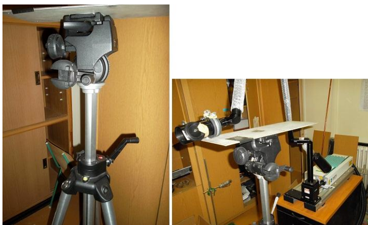
4.6. ábra: A lézerkar és az állítható állvány
