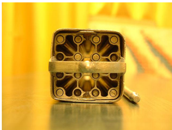
1.2. ábra: A szovjet EK-10-es típusú üzemanyag-kazetta [4]
