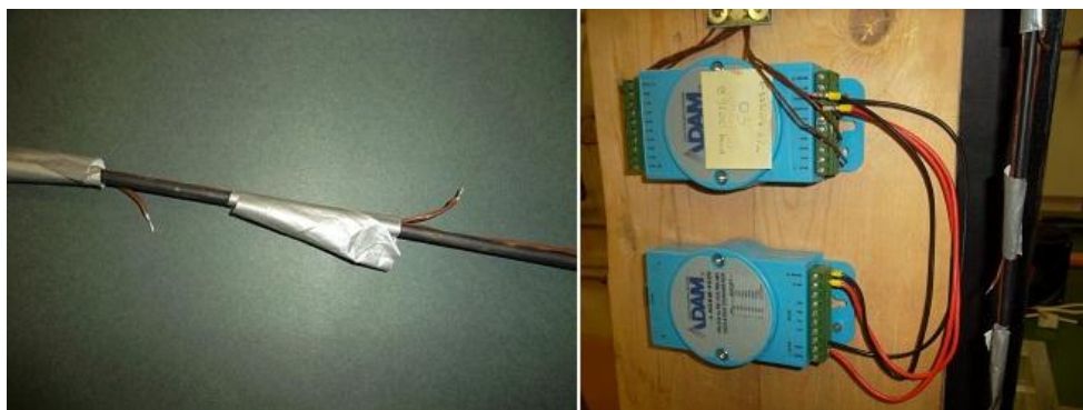
4.4. ábra: A felhasznált termoelem-sor és elektronikája
