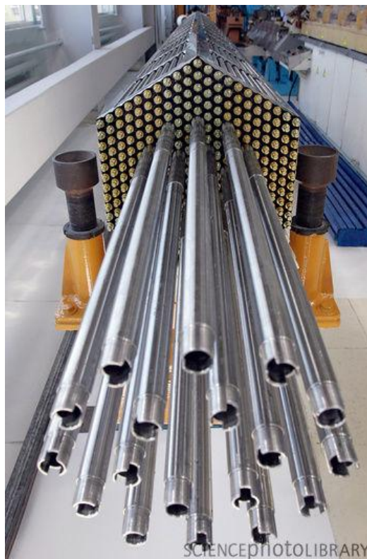
3. ábra: Négyzög (Westinghouse PWR) [5] és háromszög (VVER) [6] elrendezésű üzemanyag-kazetták
