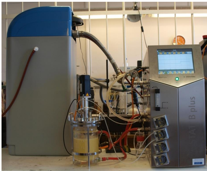
13. kép: A fermentációknál használt Sartorius B Plus típusú batch üzemű fermentor
