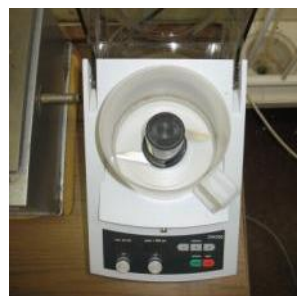
11. kép: Retsch GM200 típusú késes daráló
