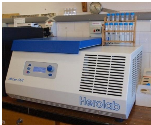
14. kép: Herolab UniCen MR típusú centrifuga
