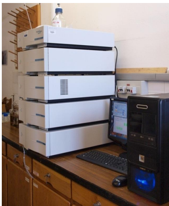
15. kép: Az analízis során alkalmazott YL9100 HPLC berendezés
