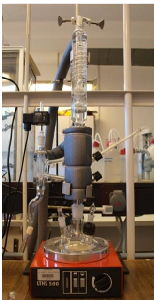
16. kép: A gőz-folyadék egyensúlyi mérésekhez használt berendezés
