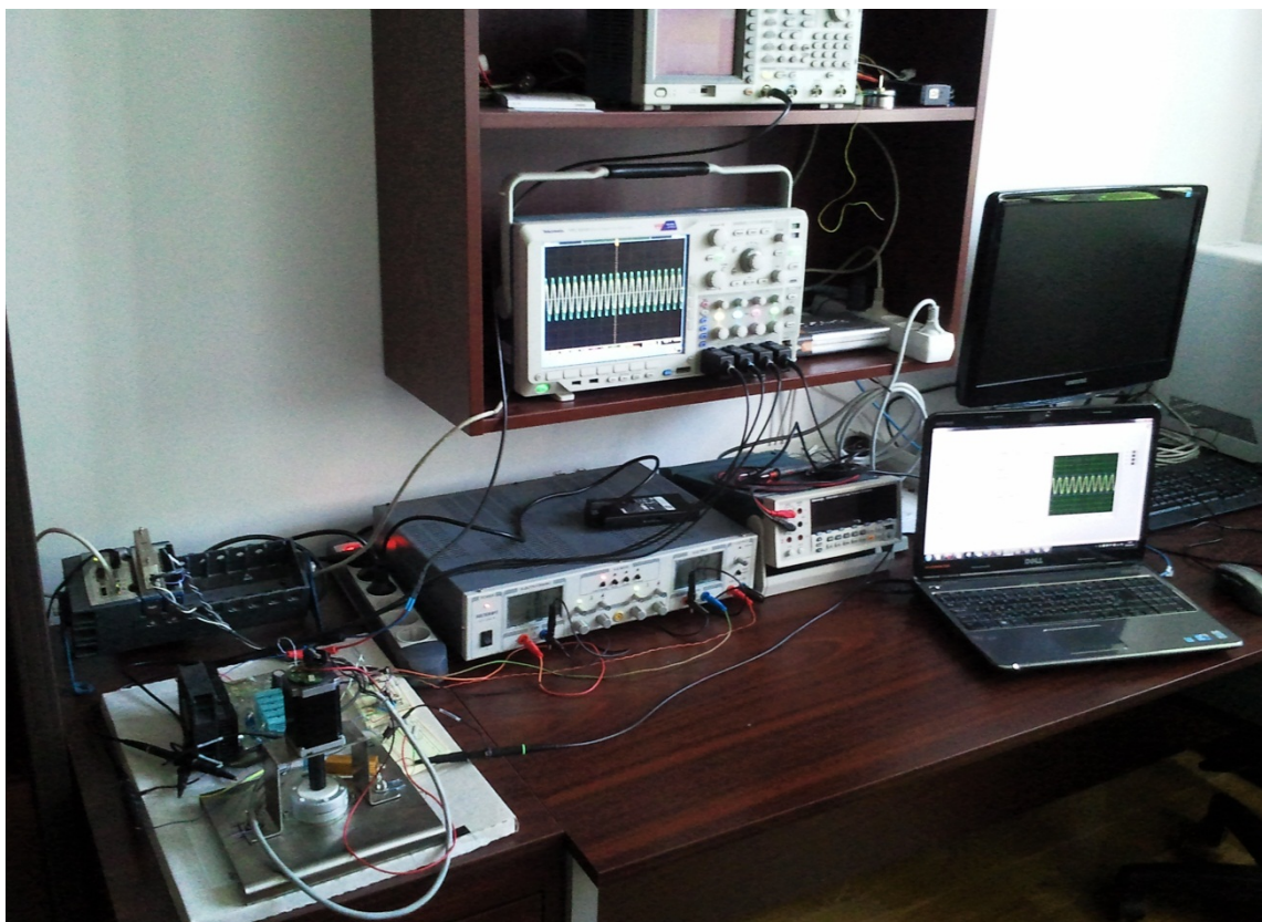
9. ábra. A kialakított automatizált mérőkörnyezet mérés közben, az állványra szerelve a Maxon EC-4pole 252463-as motor látható.
