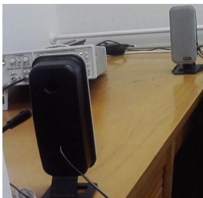
47. ábra Mikrofon hossz tengelyével megegyező irányú, lineáris mérés elrendezési elve
