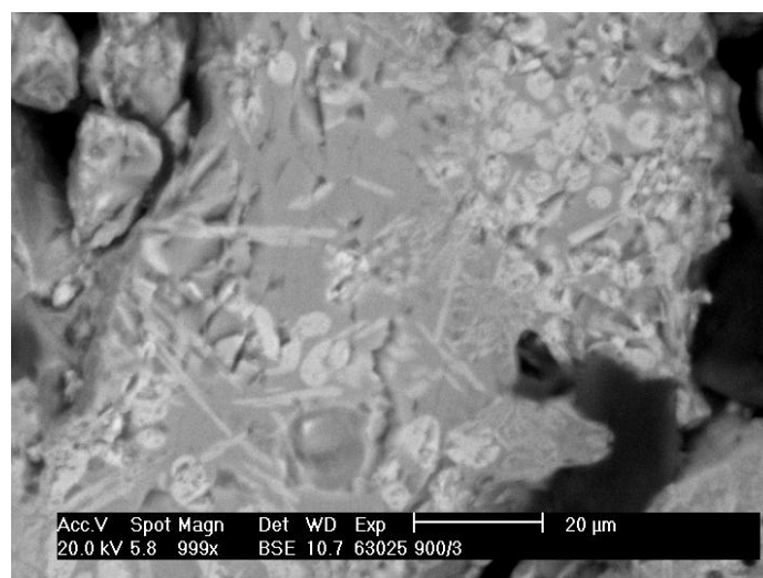
19. ábra 900°C-on hőkezelt 3. frittből készült minta elektronmikroszkópi felvétele
