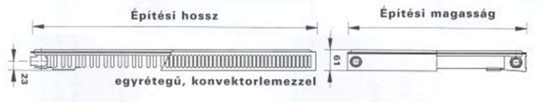
2.1.c. ábra. Egyrétegű, hátfallal felszerelt, konvektorlemezes lapradiátor.
