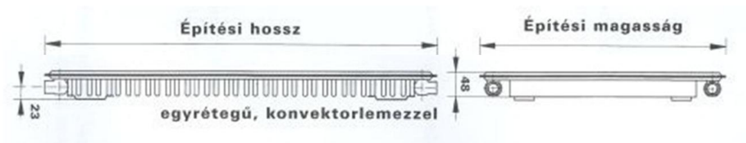
2.1.b. ábra. Egyrétegű, hátfal nélküli, konvektorlemez lapradiátor.
