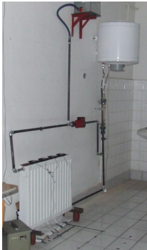
4.2.4. ábra. az összeszerelt fűtési rendszer.
