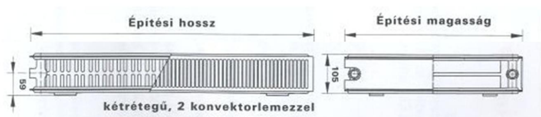
2.1.e. ábra. Kétrétegű, két konvektorlemez lapradiátor.
