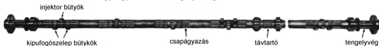
23. ábra: Több szegmensből összeállított vezérműtengely [5]
