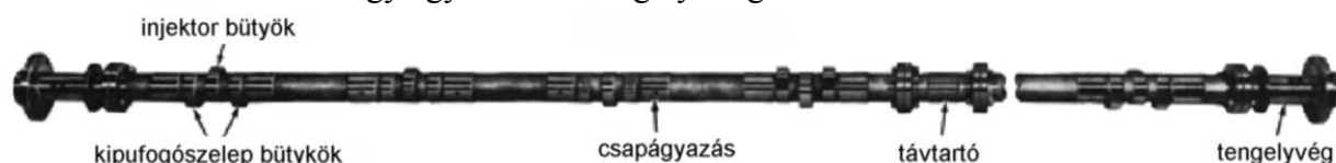
23. ábra: Több szegmensből összeállított vezérműtengely [5]
