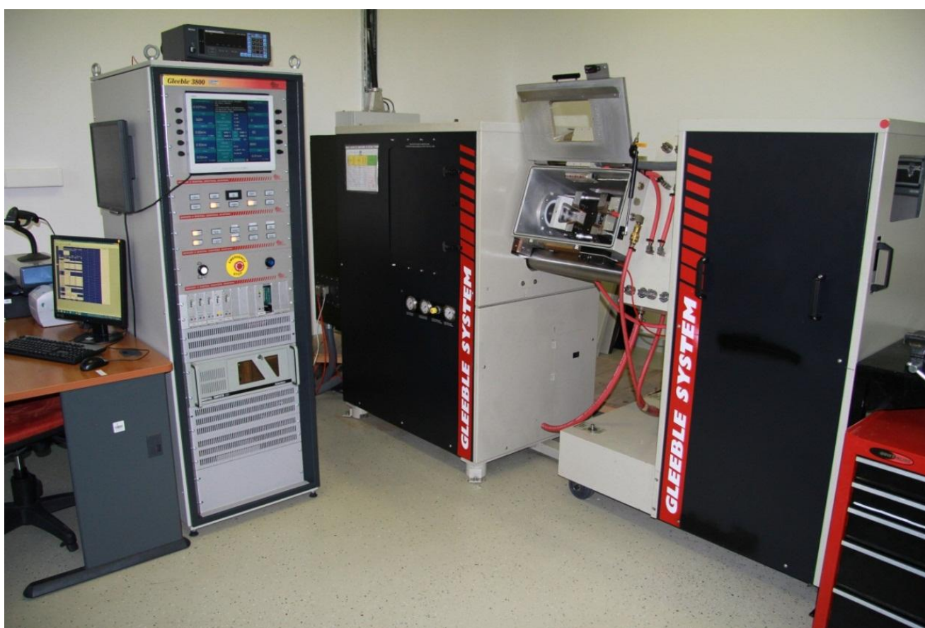
7. ábra GLEEBLE 3800 hőfolyamat szimulátor
