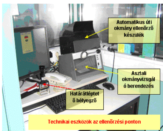
(15.kép útlevelező fülke felszerelése)
