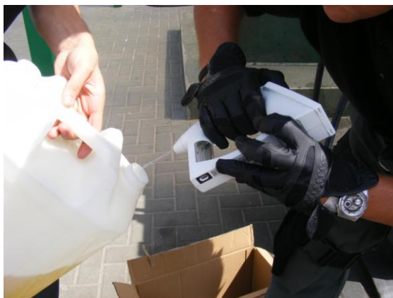
15. ábra az üres váltásra levett üzemanyag mérése digitális sűrűségvizsgáló műszerrel
