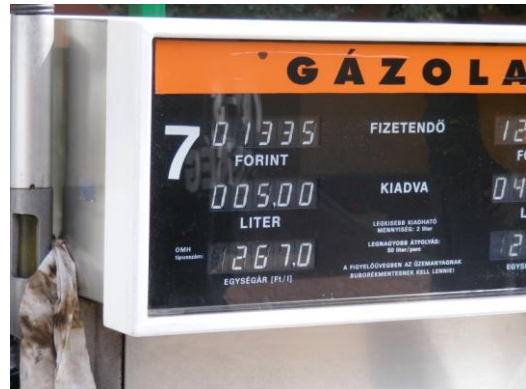
14. ábra az 5 liter üres váltás levétele a kimérő szerkezeten keresztül
