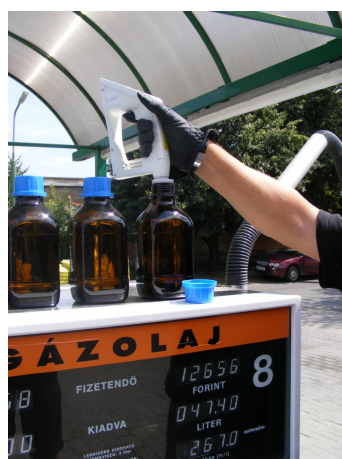
26. ábra a levett minta sűrűségének vizsgálata műszerrel A mintavételi edényeket lezáró kupakok mintaadó általi vizsgálata és a mintavételi edények lezárása valamint a gázolaj minta sűrűségének vizsgálata a digitális mérőműszerrel
