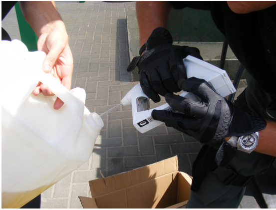
15. ábra az üres váltásra levett üzemanyag mérése digitális sűrűségvizsgáló műszerrel
