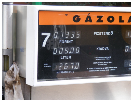
14. ábra az 5 liter üres váltás levétele a kimérő szerkezeten keresztül
