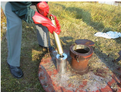
8. ábra láncos pont-mintavevő és használata
