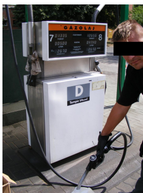
14. ábra az 5 liter üres váltás levétele a kimérő szerkezeten keresztül
