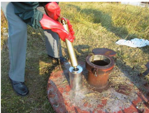
8. ábra láncos pont-mintavevő és használata
