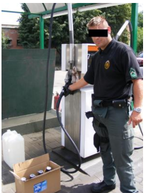
14. ábra az 5 liter üres váltás levétele a kimérő szerkezeten keresztül
