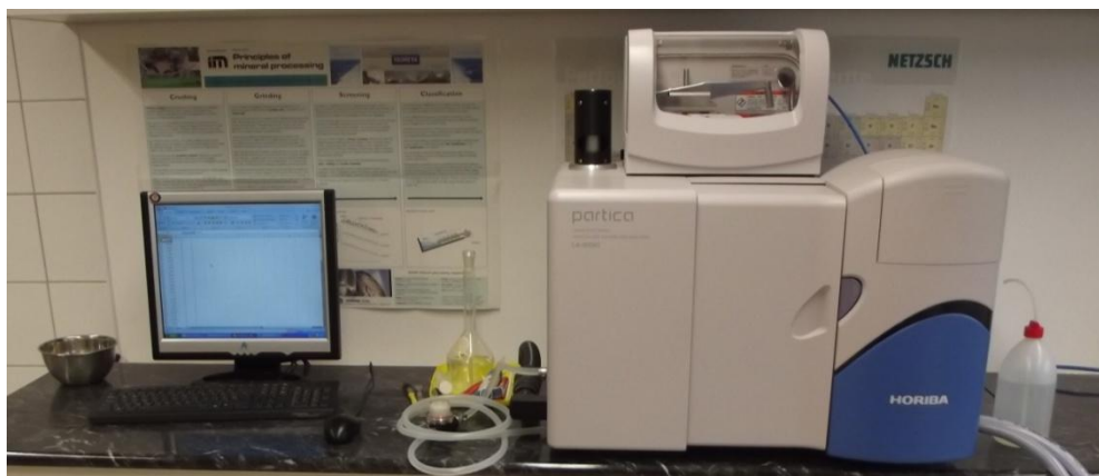
1. ábra: A tanszéki Horiba LA-950 V2 típusú lézeres szemcsenagyság elemző berendezés [Saját felvétel]
