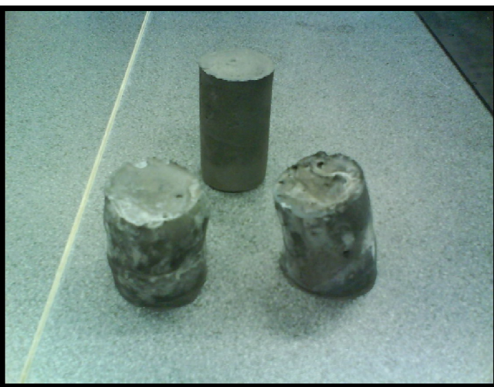
18. ábra: Nem megfelelő keverék arányú próbatestek (Hátul a megfelelő keverék arányú figyelhető meg)
