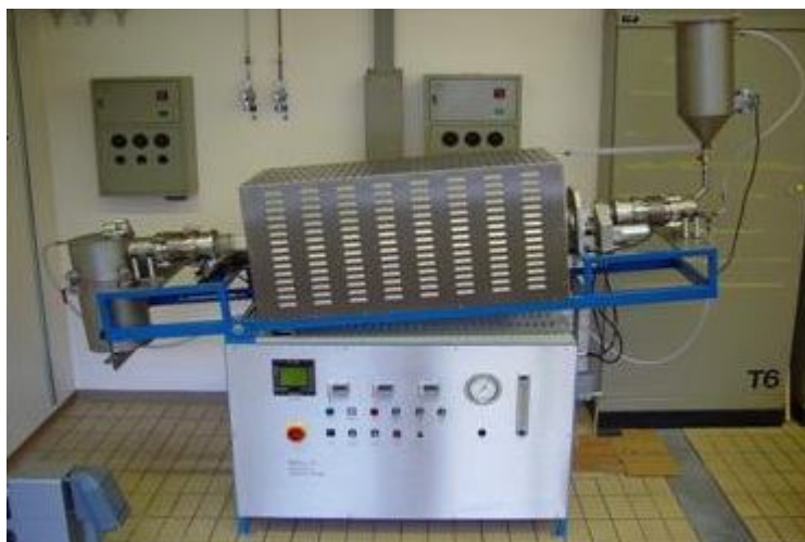
3. ábra CCVD eljárás során alkalmazott forgó csökemencés reaktor (Forrás: nanotubes.epfl.ch)
