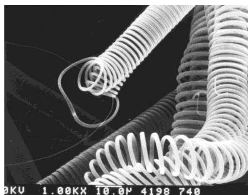
2.b ábra: Szén mikrotekerces, 790°C-on szintetizálva
